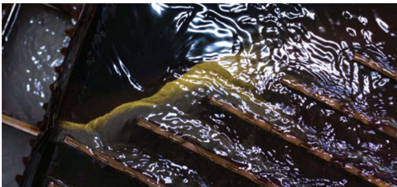
Une table d'agitation utilisant la concentration gravimétrique sans mercure dans l'une des seules usines de traitement centralisées de l'or en Mongolie, à Bayanhongkor Soum. Photo prise lors de l'expédition dirigée par Levin Sources pour former un affineur d'or à l'ASM responsable, 2016. Droit d'auteur : Magnus Arreavad.
