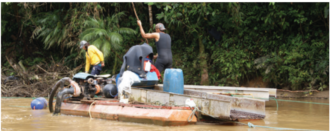
Mineurs alluviaux sur le Rio Zarza dans le sud-est de l'Équateur. Un plongeur guide une pompe aspirante pour remonter le gravier qui passe ensuite dans une écluse sur le radeau. Droit d'auteur : Kinross.
