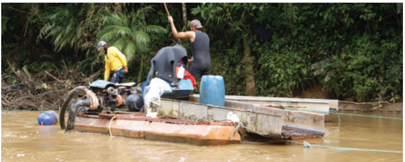
Mineros aluviales en el Río Zarza, en el sureste de Ecuador. Un buceador dirige una bomba de succión para extraer grava que luego pasa por una esclusa en la balsa. Derechos de autor: Kinross.
